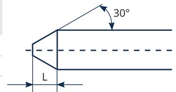
Salvo diversa indicazione da parte dell'acquirente la forma delle estremità dei prodotti di dimensioni superiori a 30 mm è a discrezione del fornitore.
